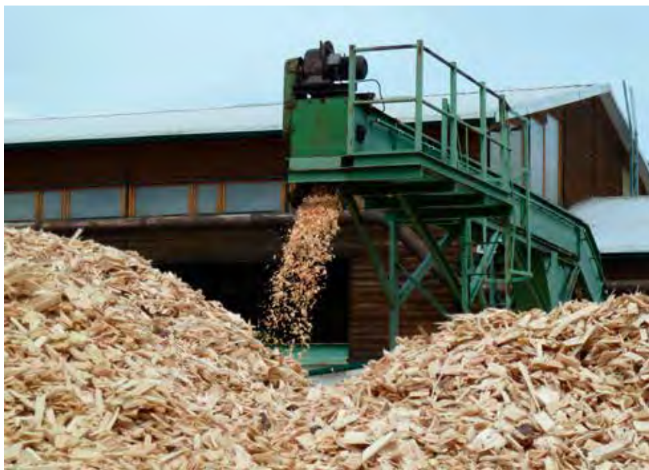
Figure 39 – Production de plaquettes de bois pour la trituration ou l'énergie à partir des chutes de bois d'une scierie
