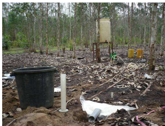
Figure 1 : vue d'ensemble du simulateur de pluie et du plateau de mesure de l'érosion
