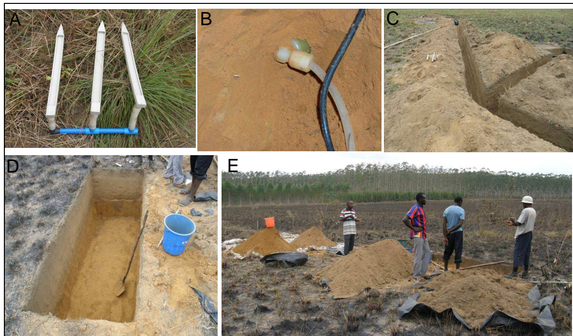
Figure 2 : photographie de la mise en place du dispositif « témoin » de collecte de solution de sol sous savane, (A) mini plaques lysimétriques, (B) bougie poreuse dans le sol, (C) tranchées reliant les trois fosses de prélèvement vers la fosse de pompage, (D) une fosse de 1m de profondeur pour la collecte des solution de sol, (E) vue d'ensemble du chantier de la mise en place du dispositif lysimétrique.
